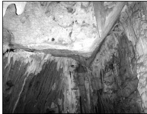
Σχήμα 3. Ασυνέχειες πληρωμένες με ασβεστιτικό υλικό. Σχήμα 4. Σχηματιζόμενη βραχοσφήνα.
