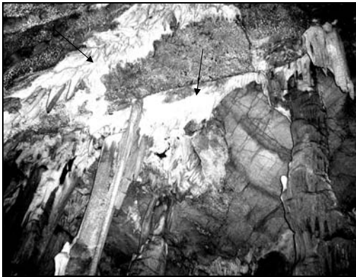
Σχήμα 3. Ασυνέχειες πληρωμένες με ασβεστιτικό υλικό. Σχήμα 4. Σχηματιζόμενη βραχοσφήνα.
