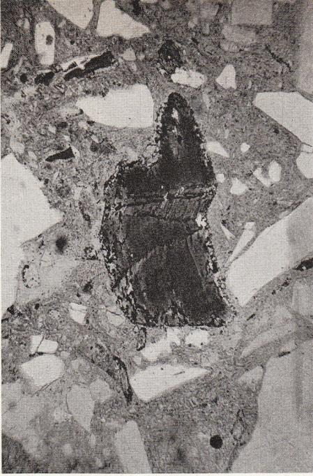
Fig. 10 Verbogener und geknickter Biotit mit Opazitrand (Opazitisierung jünger als Verbiegung).
