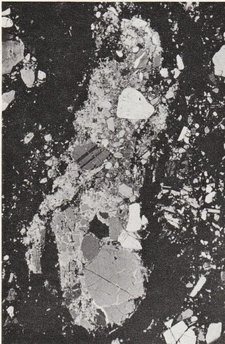
Fig. 23 Protoklastisch völlig zertrümmerter Plagioklas. Filziges Aggregat aus Calcit und Sericit, gemischt mit zerbrochenen Stücken des ursprünglichen Einsprenglings.
