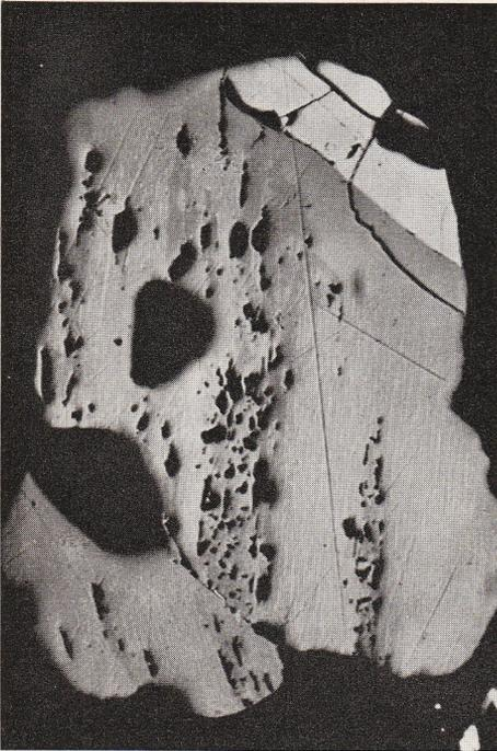
Fig. 19 Ilmenitkristall mit linsenförmigen Hämatitmagnetitmischungen. Rechts oben Magnetit (heller). Neben dem Magnetit ist der Ilmenit untermischt und heller als der übrige Ilmenitkristall. Aus Essexitdolerit, Imourada. Vergr. 300:1, Nic. parallel. Oelimmersion (Opakilluminator)
