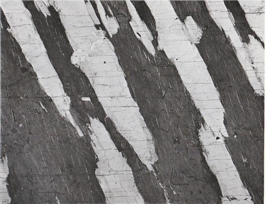
Abb. 1. Dünnschliff parallel (010) des Mikroclinperthits S 434; Perth. Gekreuzte Nicols,  $19\times$ . Parallel der im Bild horizontal liegenden Spaltbarkeit von (001) läuft die  $a$ -Achse [man schaut auf die Fläche (010)]. Der Makroalbit ( $\varrho \approx +113^\circ$ ) verläuft praktisch parallel der  $c$ -Achse, während der Mikroalbit ( $\varrho \approx +105^\circ$ ) davon deutlich abweicht. (Der Albit erscheint hier hell). Eine eingehendere Beschreibung des Materials ist in Tab. 2 gegeben.
