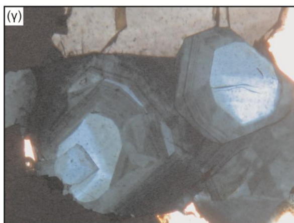
Σχήμα 2. Μικροφωτογραφίες από πολωτικό μικροσκόπιο ζωνωδών κρυστάλλων τουρμαλίνη της Νάξου. 30X, Παράλληλα Nicols. α) Κρύσταλλος τουρμαλίνη με δύο διακριτές συγκεντρικές ζώνες, β) Κρύσταλλος τουρμαλίνη (κάτω) με τρεις ζώνες ανάπτυξης, γ) Κρύσταλλοι τουρμαλίνη με πολλές ζώνες ανάπτυξης.
